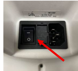
interruptor on/off - = en O = desactivado
